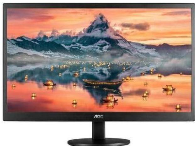
A diferença entre as telas **IPS** e monitores **LCD** são a forma como os cristais líquidos são espalhados. Nas telas **LCD** os cristais líquidos são colocados de forma vertical, já nas telas **IPS** eles são dispostos horizontalmente.
