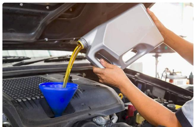
As Bases Lubrificantes são selecionadas de acordo com sua capacidade de: formar um filme deslizante protetor das partes móveis; resistir às constantes tentativas do calor e do oxigênio de alterarem suas propriedades; resistir a choques e cargas mecânicas sem alterar seu poder lubrificante; remover calor dos componentes internos do equipamento.
