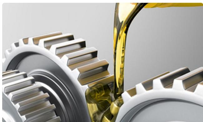
**Refrigerar:** o óleo lubrificante representa um meio de transferência de calor, "roubando" calor gerado por contato entre superfícies em movimento relativo. Nos motores de combustão interna, o calor é transferido para o óleo através de contatos com vários componentes e, em seguida, para o sistema de arrefecimento de óleo.
